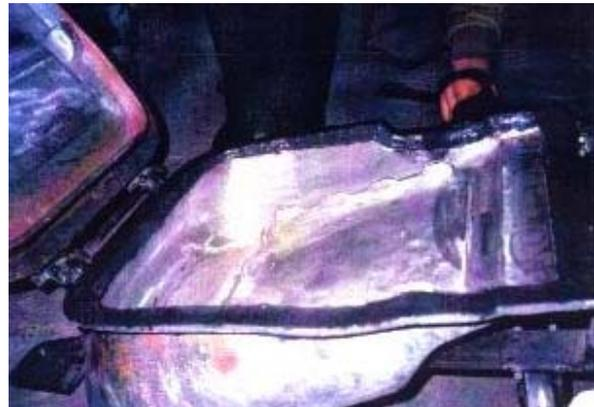
Die abdichtende Oberfläche einer Aluminiumform zur Produktion von geschäumten Kunststoffautositzen wurde repariert durch Auftragen von MM-metall SS-StahlKeramik. Die thermische Belastung beträgt 150 °C, der Druck 10 kg/m<sup>2</sup>.
