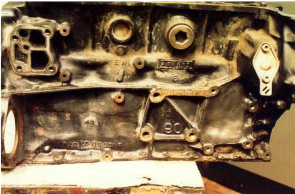
Instandsetzung eines PKW-Motors Mercedes Benz im Bereich der Kurbelwelle mit MM-metall SS-StahlKeramik und Härter gelb. Zur Verstärkung wurde ein 1 mm Stahlblech mit den Lochkonturen im Motor eingearbeitet.
