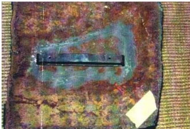
Ein mit Benzin beladener Tanker (Größe 15.000 BRT) hatte Grundberührung. Folge war eine Leckage von 200 mm x 700 mm. Die Reparatur wurde unter Wasser durchgeführt. Verwendet wurde MM-metall UW mit Härter UW9 und einer Blechplatte.
