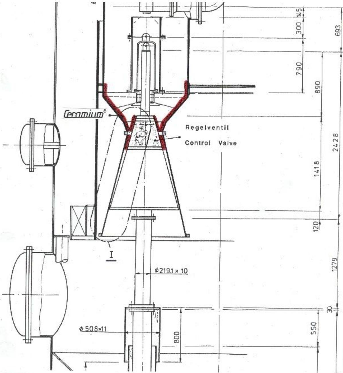
An einem Gaswascher (Venturi) einer Hochofengasreinigungsanlage wurde Ceramium mit Härter CE zum Beheben von Rissen und Erosionsschäden zwischen den Gusssegmenten verwendet. Hierdurch konnte die Lebensdauer des Bauteils verdoppelt werden.
