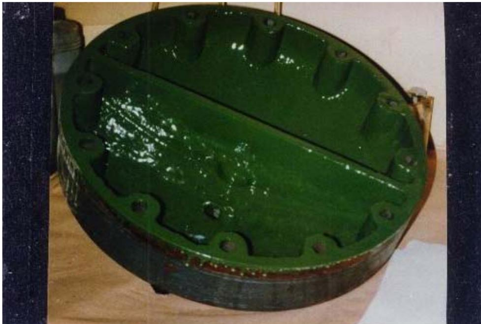
Instandsetzung eines Deckels mit Ceramium. Die Beschichtung erfolgte in zwei Arbeitsschritten: Wiederaufbau der zerstörten Oberfläche mit Ceramium, pastös. Dann folgte eine Beschichtung mit Ceramium, flüssig mit Härter CE.
