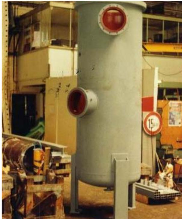
Beschichtungen mit VP 10-017 zur Auskleidung von Luftkühlern, Tanks und anderen Großflächen. VP 10-017-Beschichtungen als Oberflächen- und Korrosionsschutz bieten eine äußerst glatte, flexible und verschleißfeste Oberfläche. VP 10-017 ist temperaturbeständig bis zu 100 °C und besitzt eine sehr gute Chemikalienbeständigkeit.
