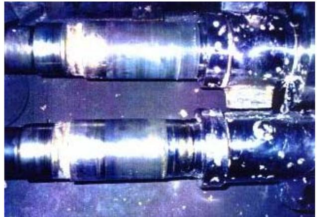
Die beschädigten Wellen einer Förderschnecke wurden mit Ceramium instand gesetzt. Eine Überprüfung nach 6 Monaten ergab keinerlei Beanstandungen an der Förderschnecke.
