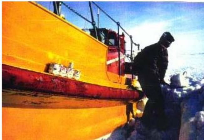
Einsatz von MM-metall UW mit Härter UW3 unter arktischen Bedingungen bei Temperaturen bis minus 20 °C.
