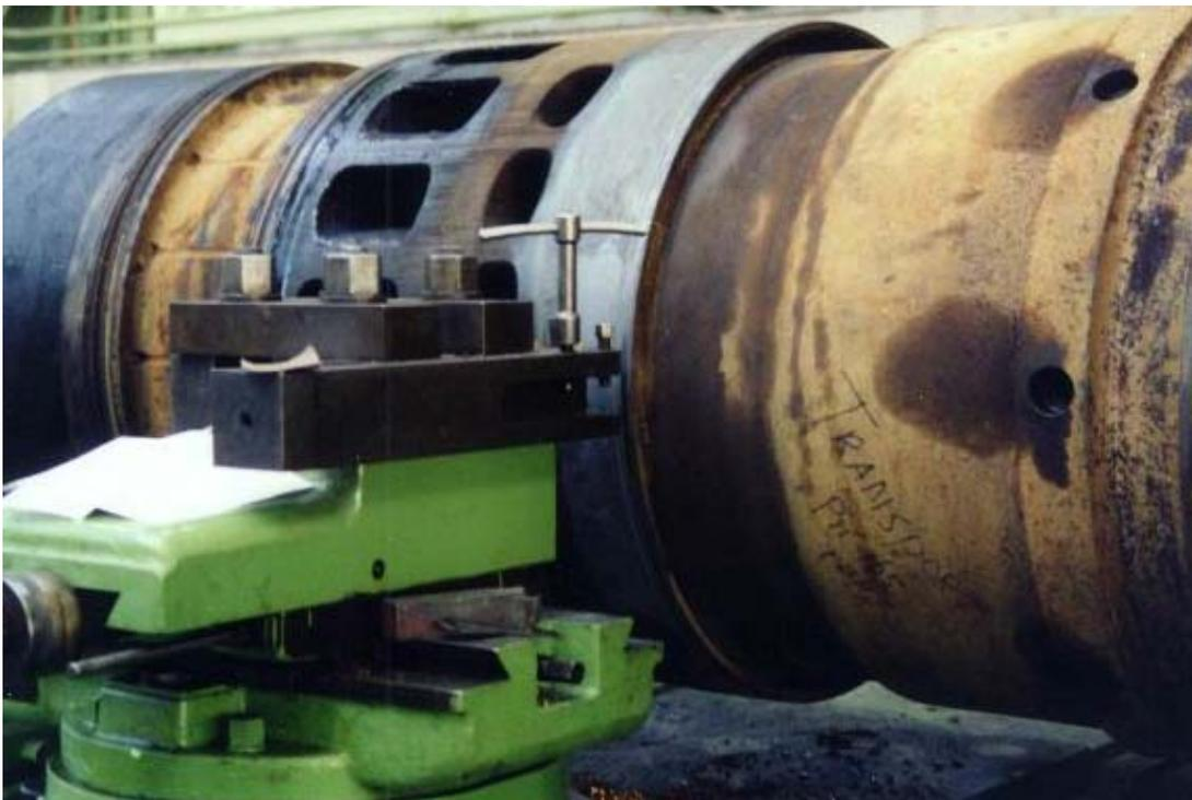
Instandsetzung von Zylinderlaufbuchsen einer Zweitakt Sulzer RND 76 N Schiffsdieselmachine im Außendurchmesser von 900 mm und im Innendurchmesser von 760 mm mit MM-metall SS-Stahl und Härter gelb
