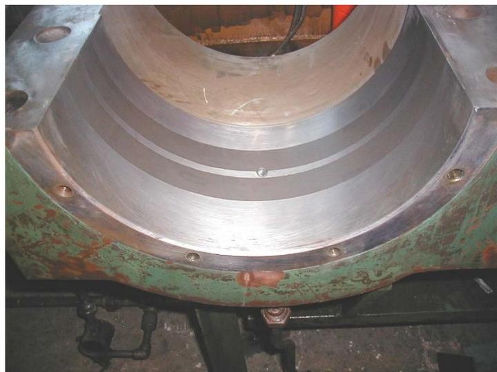
In einem Stahlwerk hätte die Instandsetzung eines defekten 40 to. schweren Getriebegehäuses durch eine herkömmliche konventionelle Instandsetzung mittels Verschweißung voraussichtlich ca 10 Tage benötigt. Durch den Einsatz der Reparaturtechnologie von MultiMetall verbunden mit dem PolymerMetall MM-metall SS-Stahl sowie MM-Trennmittel wurde eine Reparaturzeit von lediglich 27 Stunden benötigt. An dem Getriebegehäuse treten Beanspruchungen von 120 MPa auf.
