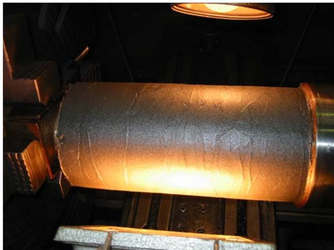
In einem Bergwerkbetrieb konnte die kosten- und zeitintensive Neuanschaffung einer Austauschwelle für eine verschlissene Welle einer Schüttelsiebzanlage durch die Reparatur mit MM-metall SS-Stahl verhindert werden.
