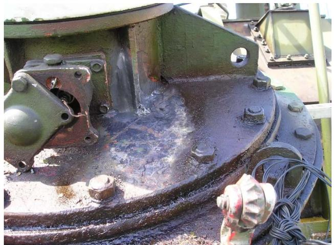
Reparatur eines vertikalen Risses einer Schweißnaht über eine Länge von ~ 80 mm durch die Verwendung der Reparaturtechnologie "direct-MM-bonding" mit Hilfe von MM-metall oL-StahlKeramik und den Härtern rot und gelb.
