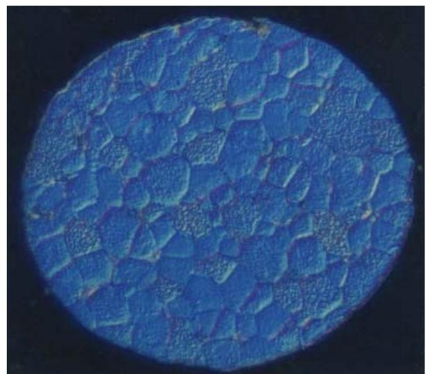
Links eine weitere Pulverteilchenaufnahme. Rechts daneben eine lichtoptische Querschliffaufnahme von einem schmelzatomisierten und rasch erstarrten Pulverteilchen.
